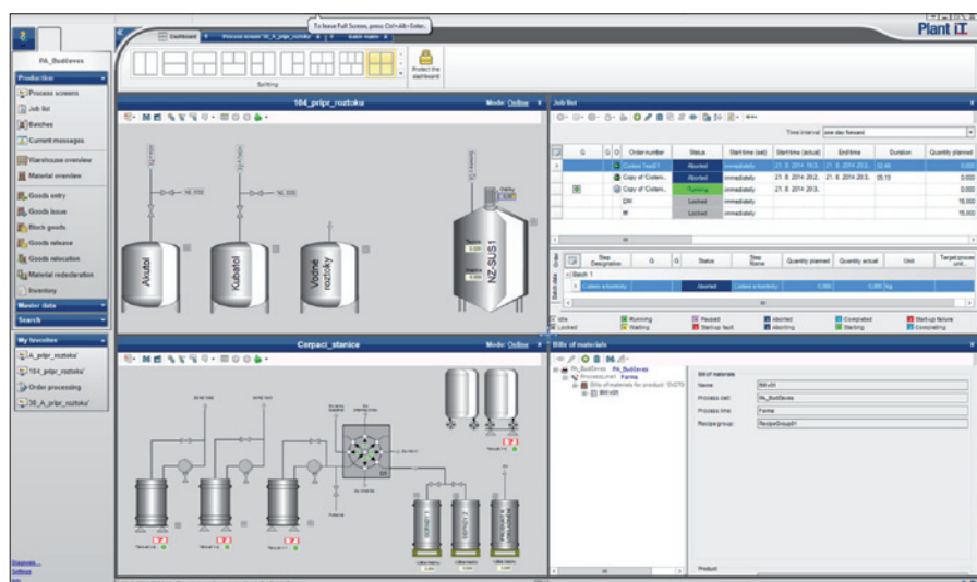
Obr. 3. Operátorské zobrazení se schématy technologických zařízení a s výrobním postupem v panelovém uspořádání
